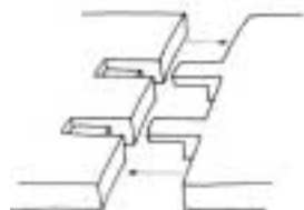
Ensamblaje por lengüetas o cola de milano.
